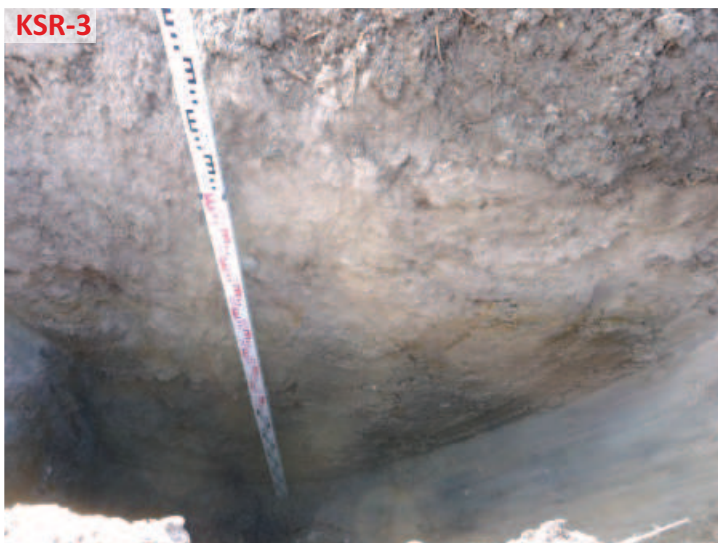
KSR-3 - odkrytý geologický profil na západoseverozápadní stěně sondy
