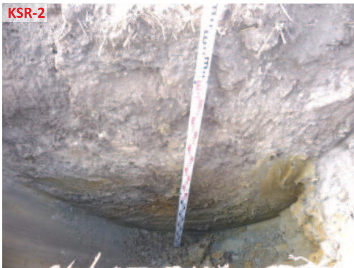
KSR-2 - odkrytý geologický profil na severozápadní stěně sondy
